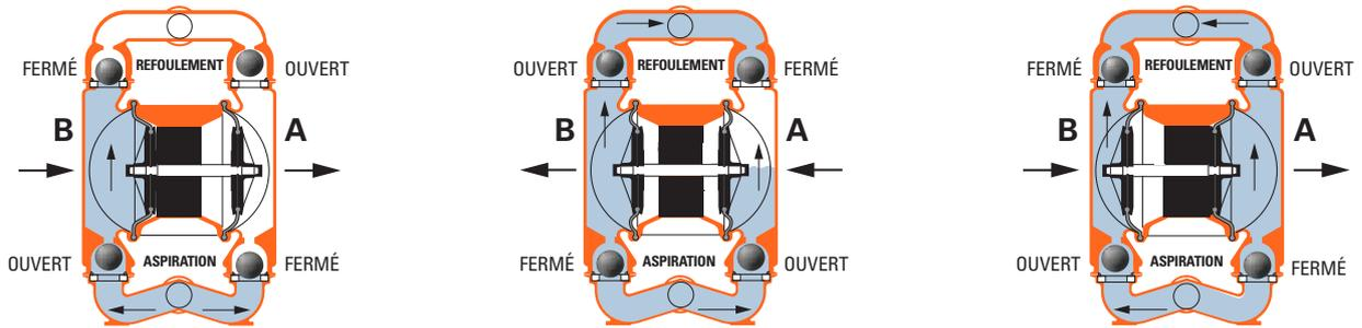
1. Le distributeur dirige l'air sous pression à l'arrière de la membrane A.
