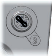
Fig. 22 : Cordon conducteur caoutchouté dans le connecteur femelle 3
