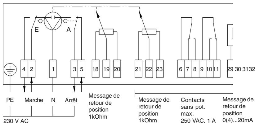
Commande via une tension d'alimentation 230V AC, 50...60 Hz
